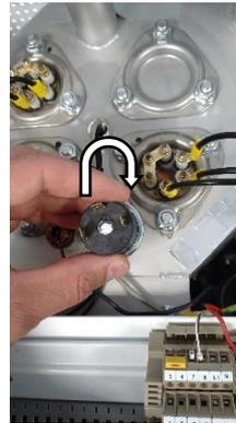
11) Serrer délicatement l'empreinte hexagonale du pressostat à l'aide d'une clé plate de 14mm jusqu'à l'écrasement du joint.
